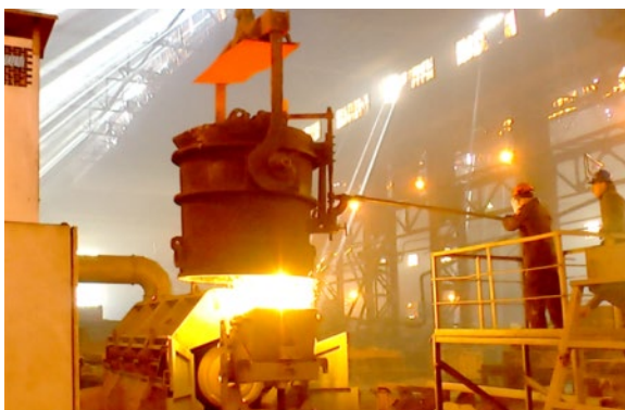
ИЗГОТОВЛЕНИЕ ОТЛИВОК МЕТОДОМ ЦЕНТРОБЕЖНОГО ЛИТЬЯ НА МАШИНЕ РМЦ 1000
