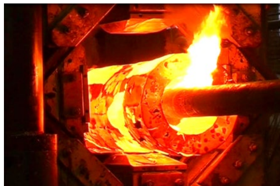
КОВКА ТРУБНОЙ ЗАГОТОВКИ В ЧЕТЫРЕХБОЙКОВОМ КОВОЧНОМ УСТРОЙСТВЕ
