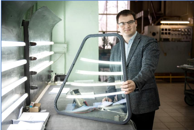
Остекление кабины экипажа самолета SJ-100
