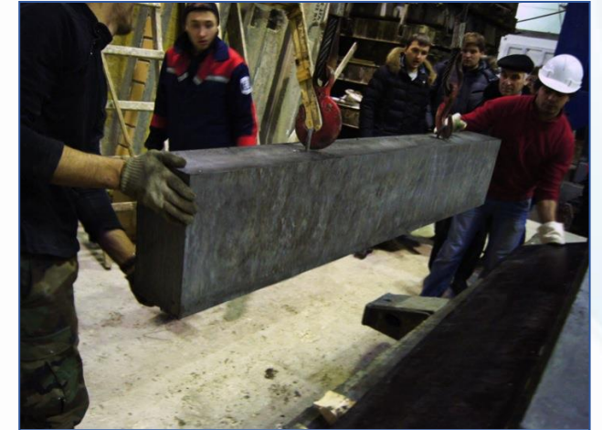
Железобетонный ригель, изготовленный из высокопрочного легкого бетона (завод Бетнар 22, Россия)
