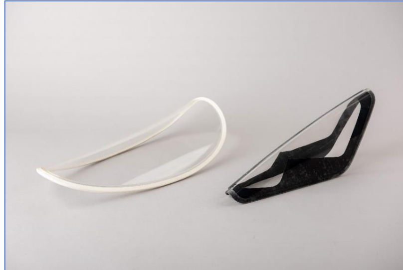
Остекление внешнего светотехнического оборудования самолета SJ-100
