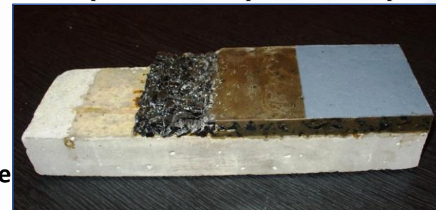
Фрагмент разработанного каркасного полимербетонного покрытия
