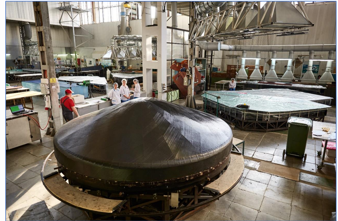
Аэродинамический экран для десантного модуля космического аппарата миссии «ЭкзоМарс»
