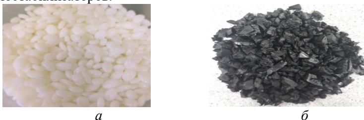
Рисунок 1 – Внешний вид исходного ТПЭЭ (сырье) (а) отходов ТПЭЭ в виде крошки (б)
