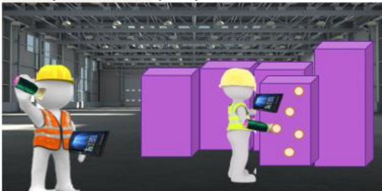
Рис. 1. Принципиальная схема оценки запаха изделий из пенополиуретана в условиях цеха с «электронным нюхачем».
