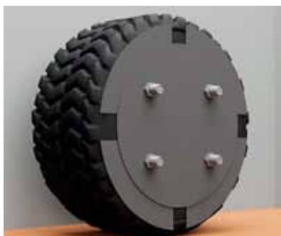
3 Модель пневмошинного рабочего органа катка с изменяющейся жесткостью
