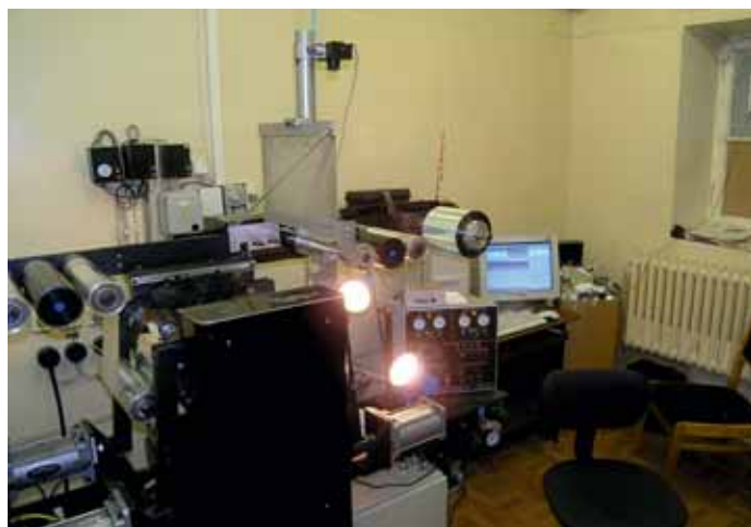
4 Система диагностики дифракционных характеристик рельефных голограмм в процессе производства
