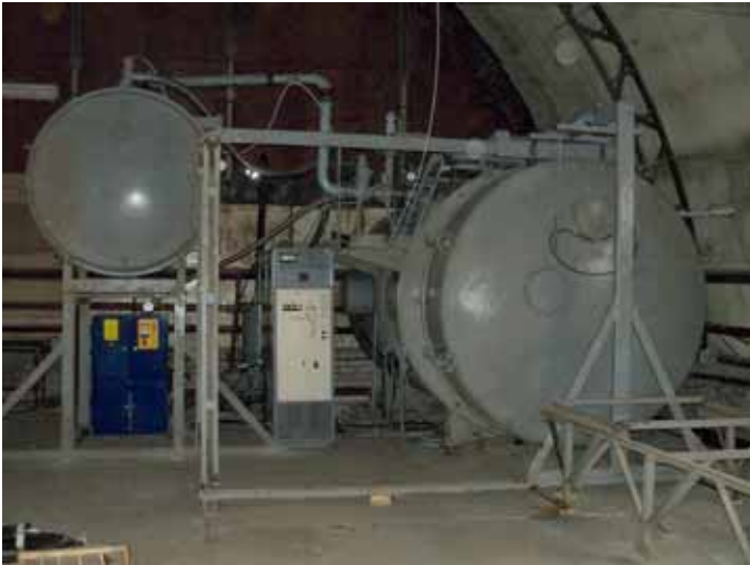
3 Установка термомодифицирования пиломатериалов, которую внедрил в Подмосковье Р. Р. Сафин
