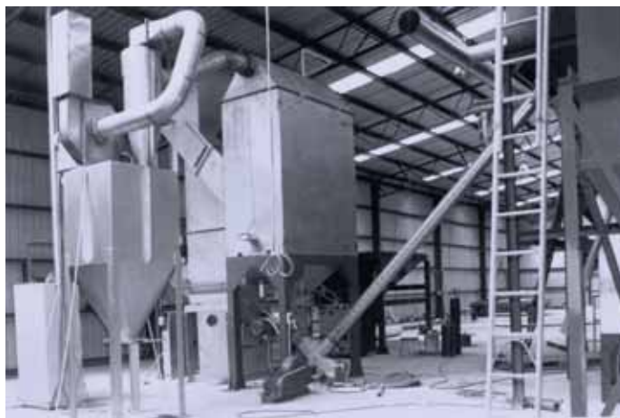
2 Установка МВУ-2 для вспучивания вермикулитовых концентратов
