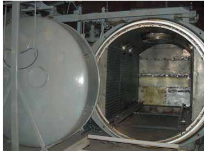
3 Установка термомодифицирования пиломатериалов, которую внедрил в Подмосковье Р. Р. Сафин
