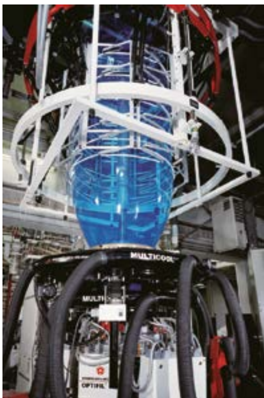
Рис. 7-3. Линия экструзии пленки с выдуванием и водяным охлаждением производства компании Windmoeller&Hoelscher.
