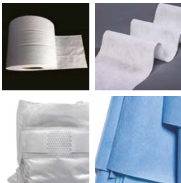
Рис. 7-52. Материалы из биоразлагаемых пластмасс, получаемых выдуванием из расплава, и изделия из них
