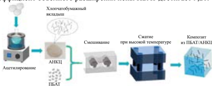
Рис. 5-7 Приготовление композитов из ПБАТ/АНКЦ. [30]
