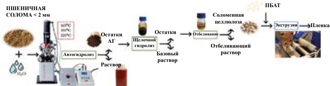
Рис. 5-10 Получение смеси целлюлозы из соломы пшеницы и ПБАТ. [33]
