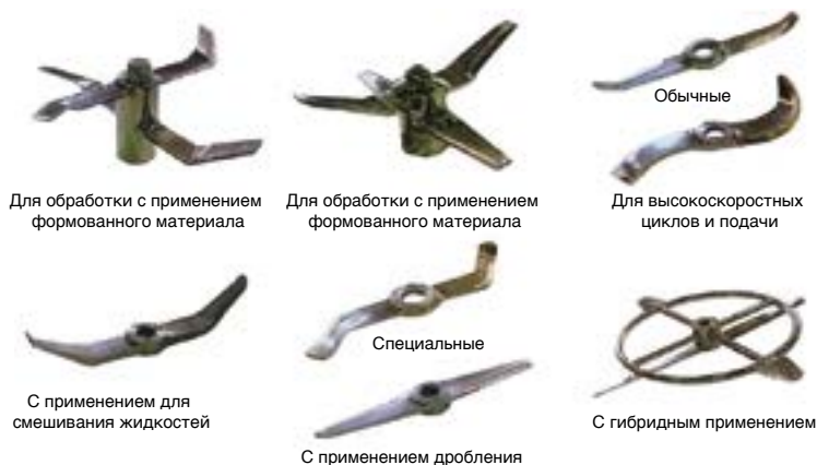
Рис. 6-39 Лопасты высокоскоростных смесителей
