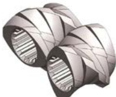
Рис. 6-24 Перемешивающие элементы со скручиванием
