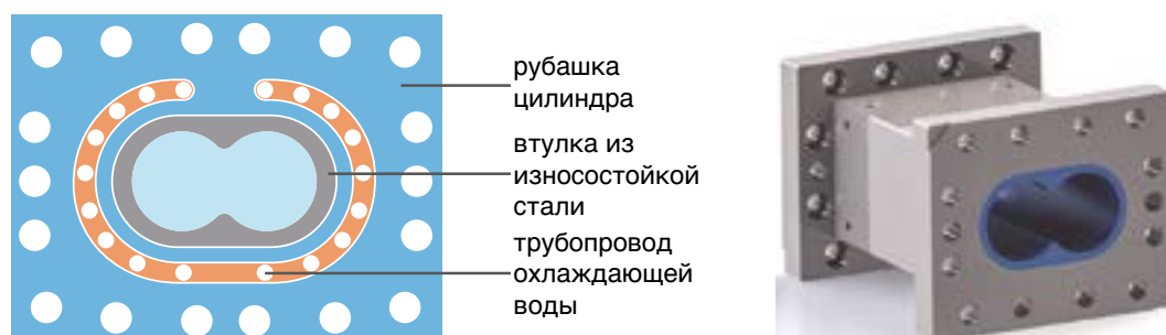
Рис. 6-14 Схема конструкции цилиндра
