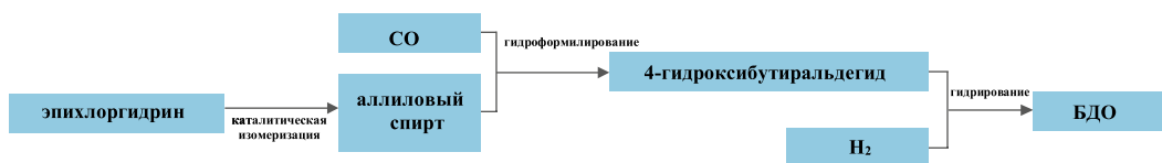
Рис. 2-6 Технологический маршрут метода получения БДО с использованием аллилового спирта
