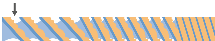
Рис. 6-32 Влияние изменения хода на заполнение
