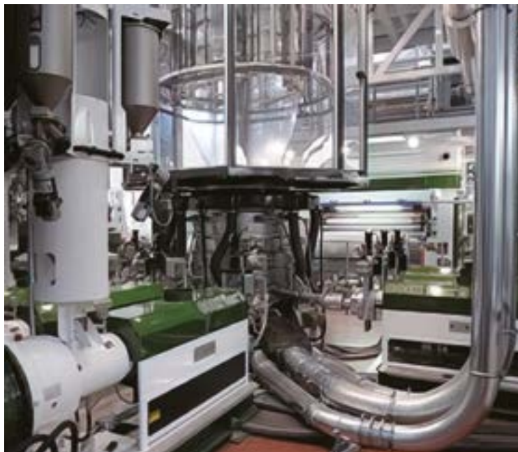
Рис. 7-5. Линия производства компании Maschi для совместной экструзии 9 слоев
