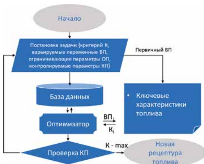
1. Схема расчетно-экспериментального исследования по созданию нового авиационного топлива
