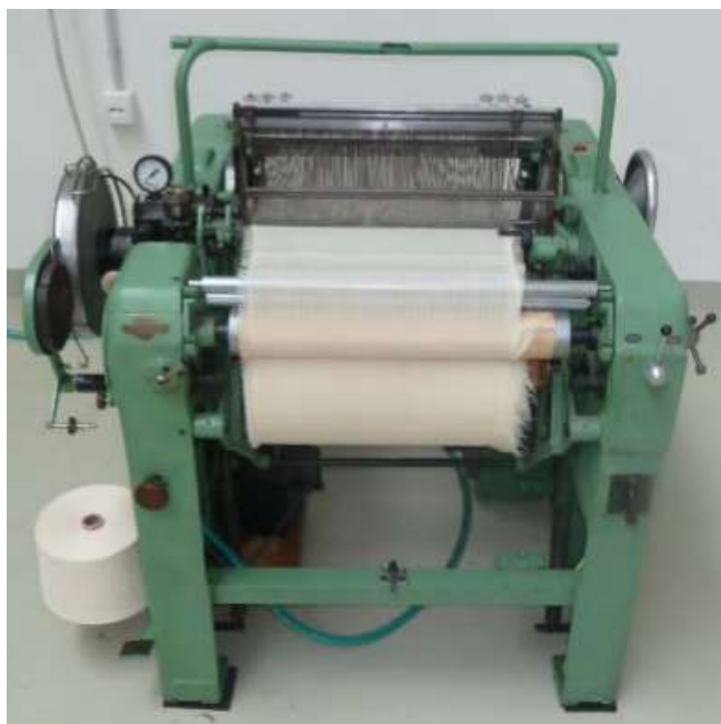
Рис.1. P 45 - первый пневматический ткацкий станок, 1952 г.
