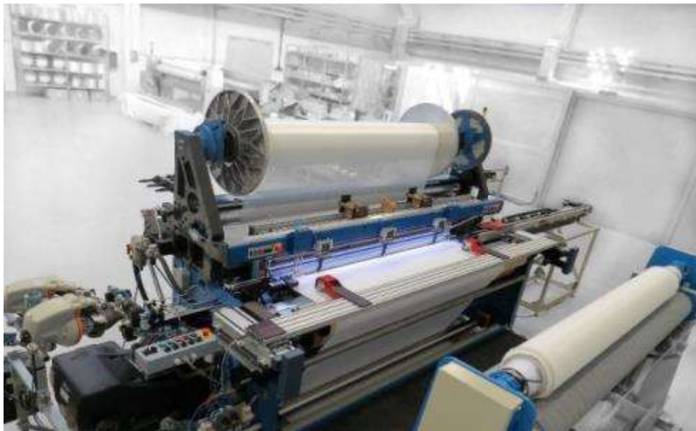
Рис.3. Пневматический ткацкий станок DIFA для 3D объёмных тканей
