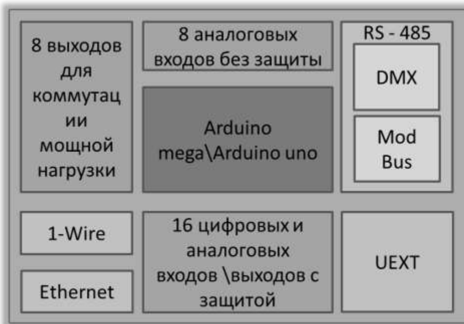
Рис. 1. блок схема контроллера для осуществления концепции IoT
